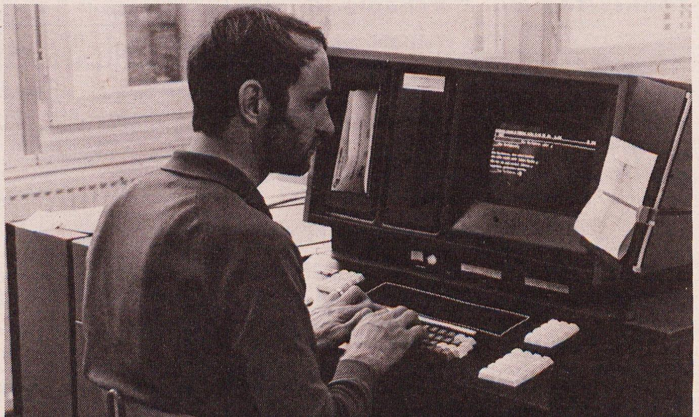
Fotosatzmaschine Compugraphic 7500. Links der Belichtungsteil, rechts die Tastatur (im Innern ein 32K-Computer), oben der Bildschirm und links davon die Datenspeicherung mit Floppydisc.
